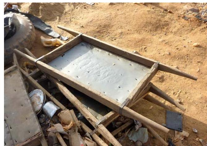
Les portoirs à sable sont constitués d'un cadre de bois et d'une plaque de tôle percée pour laisser l'eau s'écouler.
