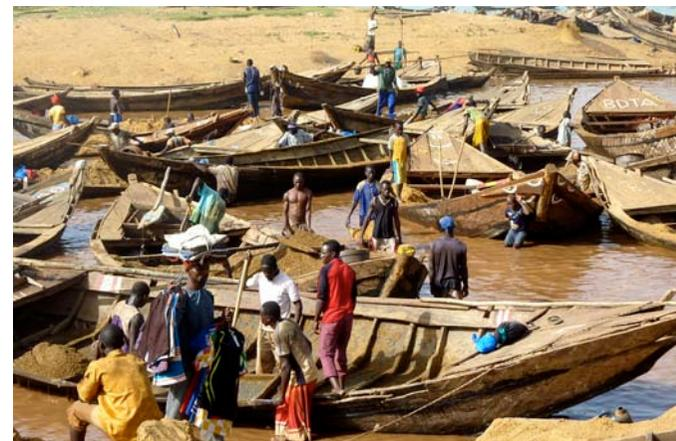
Sur le port sablier de Bamako, des centaines de manoeuvres travaillent. Les piroguiers partent à 7 ou 8 kilomètres en amont pour charger le sable au seau. A leur retour, les déchargeurs prennent le relais pour vider les pirogues qui contiennent de 4 à 6 tonnes de sable ou de graviers.
